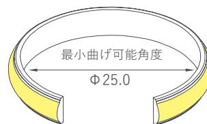
IP54ノーマル仕様(通常仕様)・ストレートフィードのみ対応
